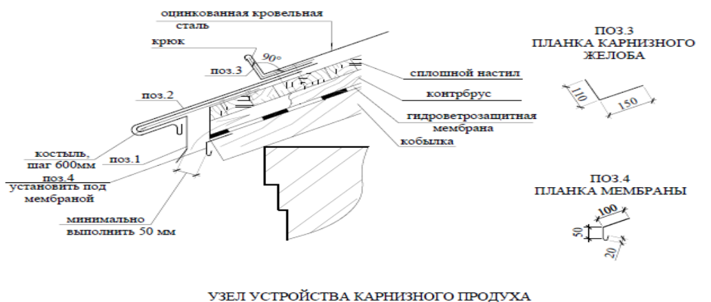
УЗЕЛ УСТРОЙСТВА КАРНИЗНОГО ПРОДУХА
