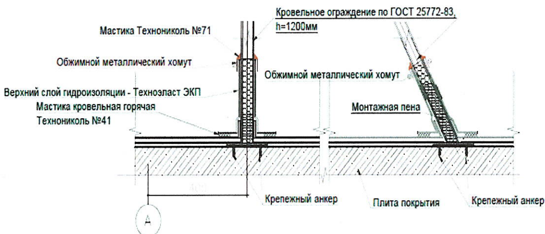
Рисунок 23 - Крепление ограждения на горизонтальную поверхность наплавлиемых крыш
