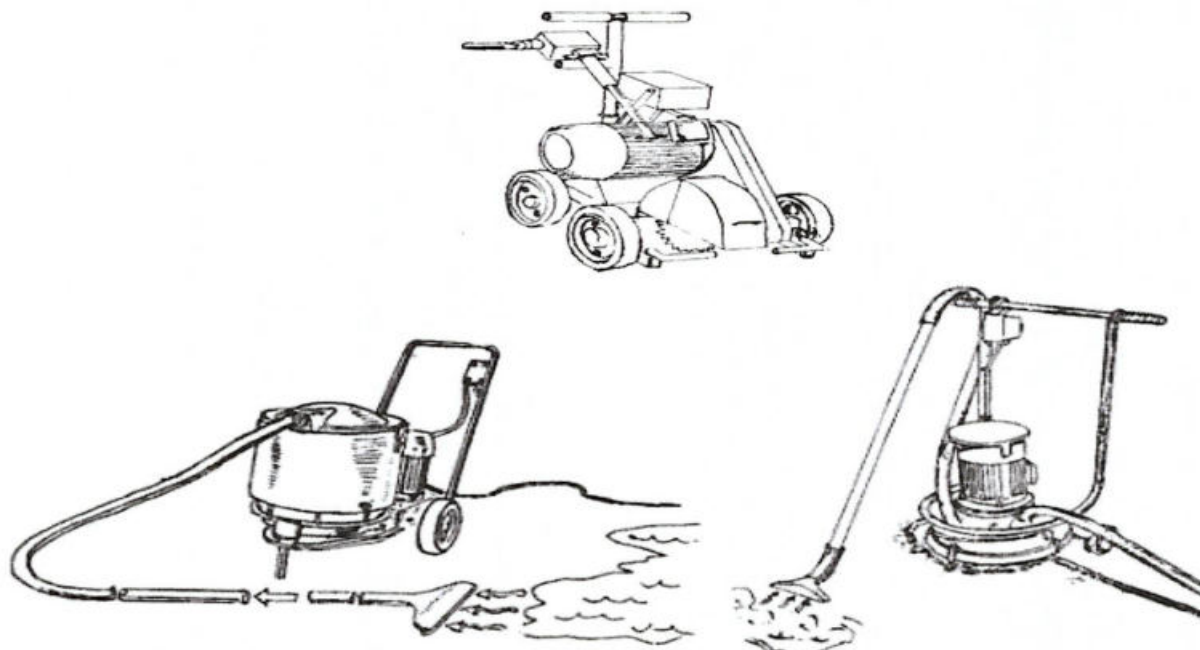
Рис: Машина для резки рулонного битуминозного кровельного ковра на полосы и машины для отсоса воды подкровельного основания: СО-106А (слева), СО-222 (справа)
