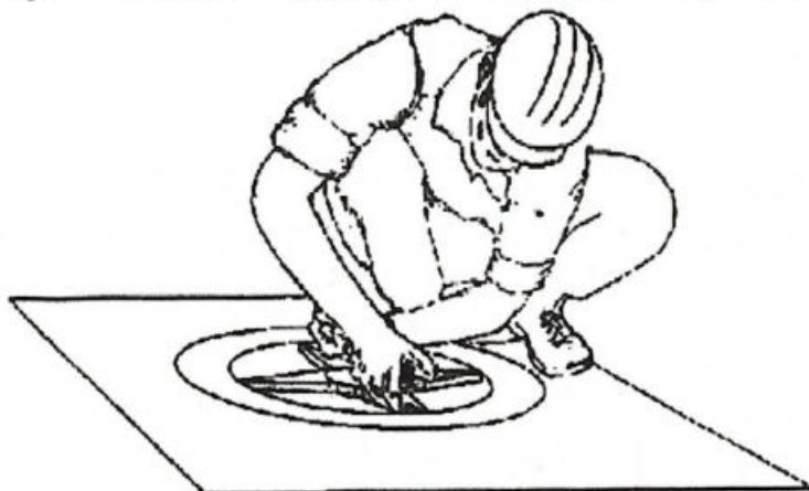
рис: Наклейка двух слоев рулонного материала на воронку внутреннего водостока
