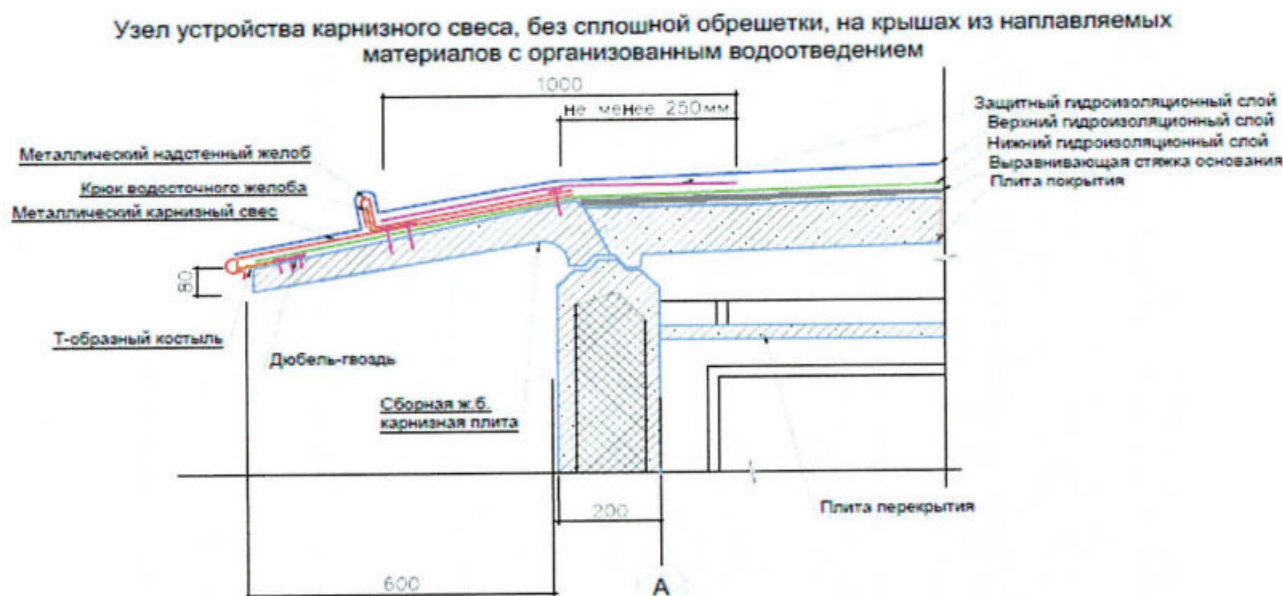
рис: Узел устройства карнизного свеса, без сплошной обрешетки, на крышах с организованным водоотведением
