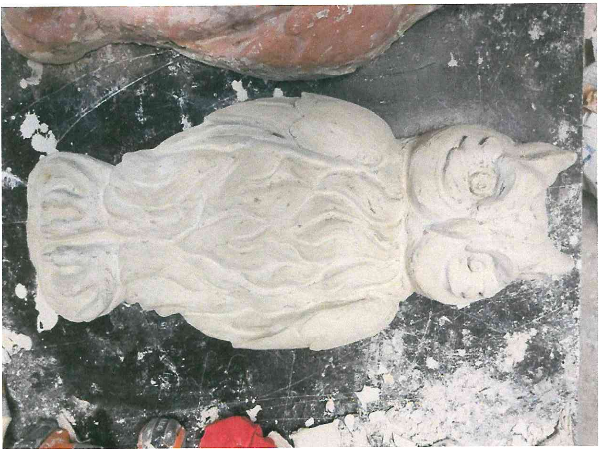
Илл. 9 Замыленный элемент, не подлежащий восстановлению, и новая отливка в фибробетоне
