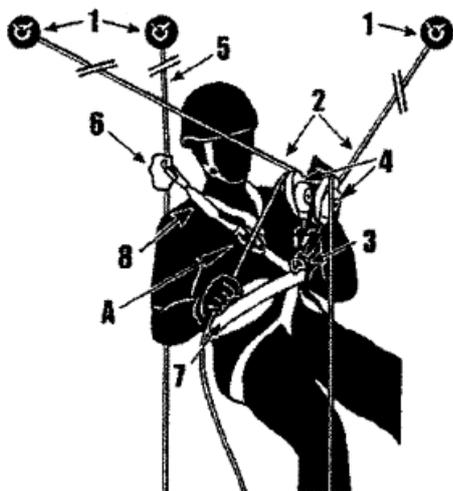
Система канатного доступа обеспечивает работнику доступ к рабочему месту и возврат обратно, выход на поверхность площадки и изменение в рабочей позиции, предоставляет опору и позиционирование, защищая от падения, обеспечивая при необходимости спасение с высоты.
