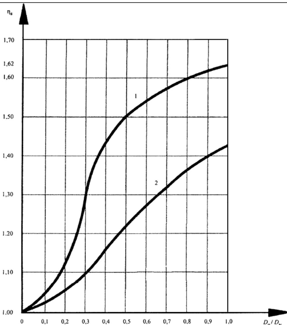
$\eta_b$  - коэффициент несущей способности деталей;  $D_o/D_{ж}$  - отношение наружного диаметра ответвления тройника к наружному диаметру основной трубы тройника
