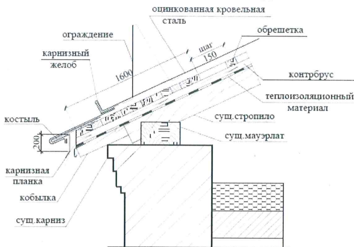
Рис 10-2. Узел устройства карнизного свеса. Вариант 2.
